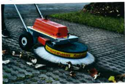
Radialbesen sind für fast jedes Kehrgut anwendbar und direkt einsatzbereit. (Foto: Westermann GmbH & Co. KG)
