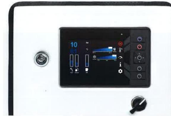
übersichtlich auf einem großen Farb-Display angeordnet. Alle Tankfüllstände und aktuellen Werte wie Druck, Drehzahl der Pumpe und Wassertemperatur lassen sich auf einen Blick überwachen und anpassen.
