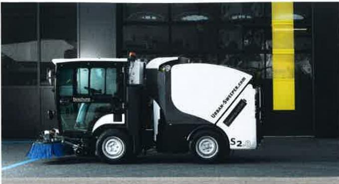
Die Panoramakabine der S2.0 ist mit einer Lüftungs- und Klimaanlage inklusive Feinstaubfilter der Klasse F8 ausgerüstet. | Foto: Boschung
