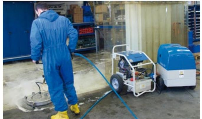
350 bar und Heißwasser im Einsatz bei der Reinigung eines Werkstattbodens
